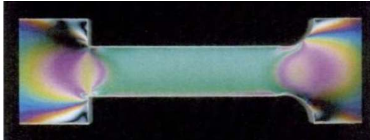
FIGURE 3.25 – Influence d'un congé de raccordement sur une éprouvette de traction : observations en photoélasticité (franges isochromatiques).
