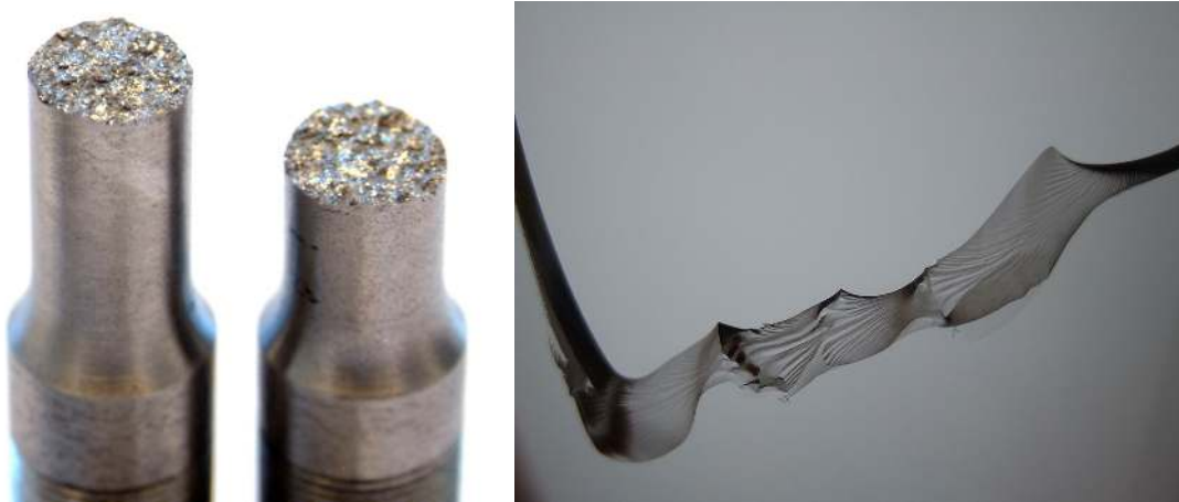
FIGURE 3.7 – Faciès de rupture dans le cas de la fonte (à gauche) et du verre (à droite).
